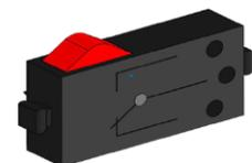
Wird der Taster betätigt, besteht eine leitende Verbindung zwischen Kontakt 1 und Kontakt 3, während die Verbindung zwischen Kontakt 1 und Kontakt 2 getrennt wird. Die Abbildung zeigt das schematische Schaltbild des Minitasters.
