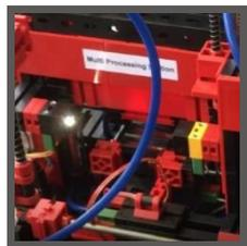
Das Werkstück wird eingeschoben, gebrannt und wieder aus dem Ofen herausgefahren. Der bereitstehende kleine Transportschlitten mit Vakuum-Sauger übernimmt den Transport zur Bearbeitungsmaschine „Fräse“.
