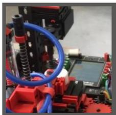
Der Transportschlitten mit Vakuum-Sauger legt das Teil auf den Drehtisch mit dem dieses dann zur Fräse gedreht wird. Nachdem der Fräsvorgang durchgeführt wurde, wird das Werkstück um 90 Grad weitergedreht und pneumatisch auf ein Förderband geschoben.
