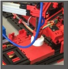
Dieser legt das Werkstück zur Endbeschriftung auf den NFC-Reader. Dort wird es mit werkstückrelevanten Daten wie z.B. Bestelldatum, Herstellungs- oder Auslieferungsdaten beschrieben.
