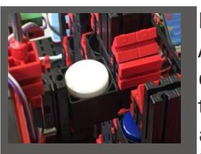
Der Container mit der Rohware wird in der Ein-/Ausgabevorrichtung zur Aufnahmeposition des Greifarms des Hochregallagers transportiert. Hier wird der Container abgeholt, zur Lagerstätte im Hochregal befördert und dort abgelegt.
