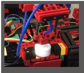
Daraufhin fährt der Vakuum-Sauggreifer zur Einlagerungsposition, nimmt die Rohware auf und bewegt sie zum NFC-Reader.
