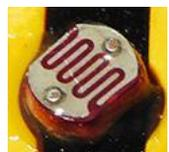
**Wichtig:** Der Fotowiderstand hat einen Widerstandswert von 0 - >1M $\Omega$ m (bei vollkommener Dunkelheit). In der Software lässt sich am TXT Controller ein Wert von maximal 15.000 ablesen
