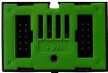
Der im Gehäuse auf einer Platine befindliche Sensor dient zur Messung von Gas, Luftdruck, Feuchte- und Lufttemperatur. Der Baustein wird über ein
